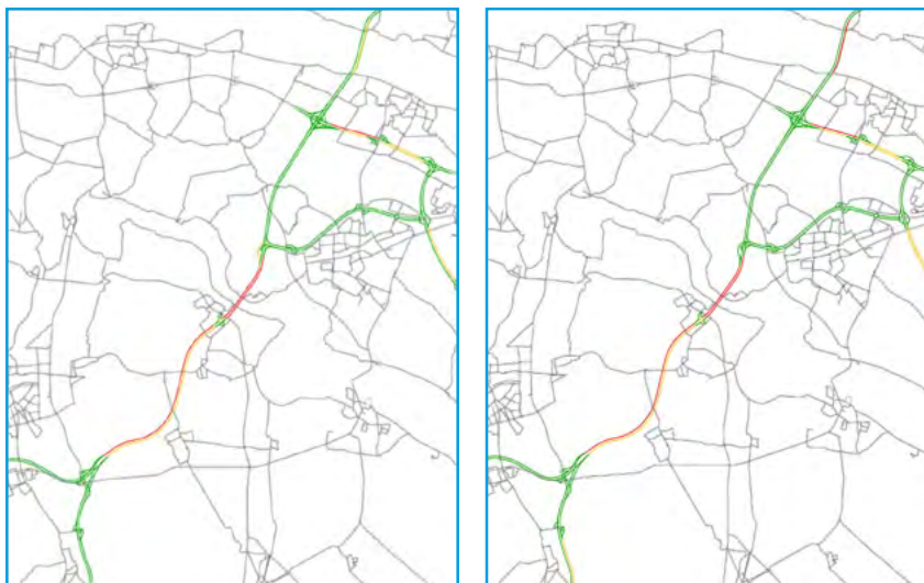
Figuur 2-2. I/C verhoudingen ochtendspits (links) en avondspits (rechts) op basis van NRM-oost 2018 (basisjaar)
